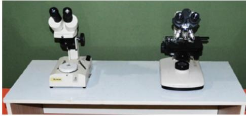
**Figura 23** – Lupa estereoscópica e microscópio para a observação de estruturas dos corpos dos insetos.
